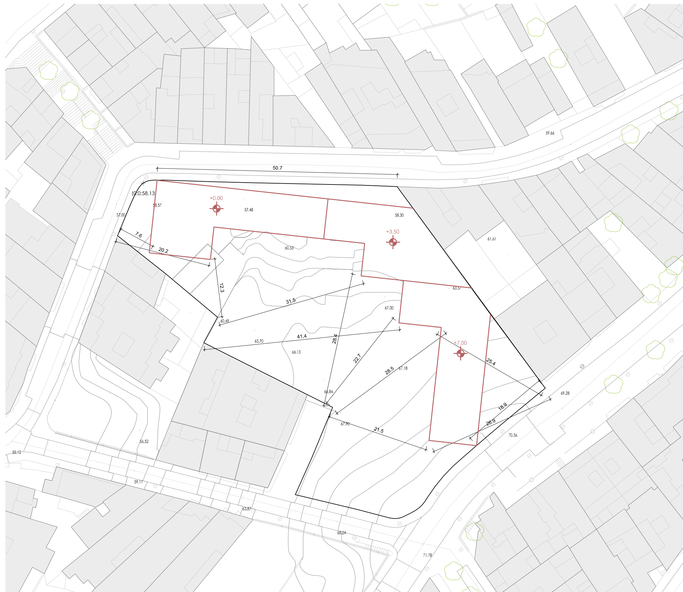
Esquema de replanteig (Forat d'excavació)
